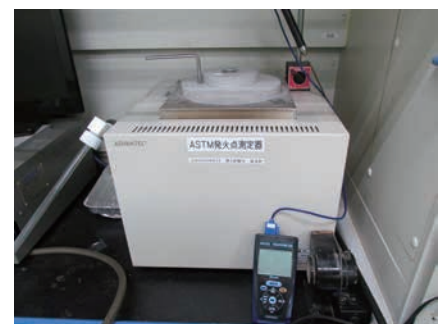
発火点測定試験
