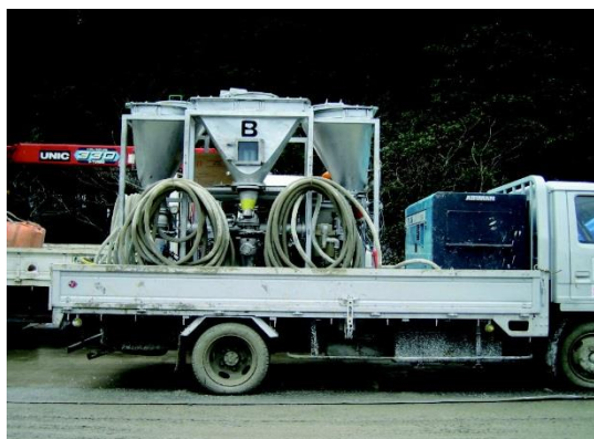
装填機搭載状況 (4 t 車)
